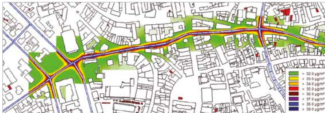
Distribución de NO 2 a lo largo de una carretera, teniendo en cuenta la influencia de los edificios
